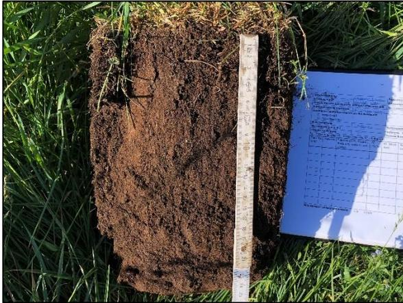
**Abb. 2.** Oberbodenmonolith zur Ansprache des Oberbodens. Erkennbar sind die im Zuge der Entwässerung stark mineralisierten Torfe. Der Oberboden weist zudem eine hohe Verdichtung auf (30.05.2023).
