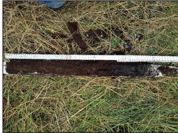
Abb. 3. Ausschnitt aus der Moorklappsonde. Die Torfe im Gebiet sind durch die langjährige Entwässerung stark degradiert (13.07.2022).
